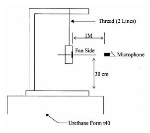
1 METER FROM MICROPHONE TO FAN INTAKE
