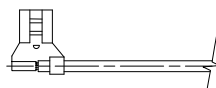
6,3x0,8 o 4,8x0,8 Faston femmina a bandiera 6.3x0.8 or 4.8x0.8 Female flag rolled receptacle
